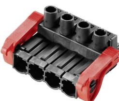
Connettore maschio inverso a 180° con collegamento a staffa di serraggio per il cablaggio in campo da 2,5 mm<sup>2</sup> con passo 7,62. Ideale anche come soluzione di protezione contro i contatti accidentali per le tensioni inverse.
