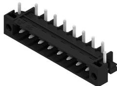
Connettore maschio aperto, diritto, resistente alle alte temperature Imballaggio in scatola o Tape. Su Tape e con codolo a saldare da 1,5 mm, ottimizzati per l'equipaggiamento automatico. Codolo a saldare da 3,2 mm, indicato per saldatura reflow e a onda. Le strisce di connettori maschio presentano uno spazio per la siglatura e sono codificabili. HC = High Current (a corrente forte).
