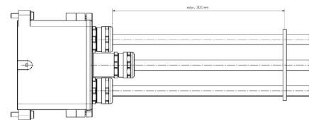
Per evitare danni ai contatti e ai manicotti isolanti, si consiglia di fissare il cavo. Le distanze corrispondenti sono mostrate nel disegno seguente. Il fissaggio del cavo non è incluso nel volume di consegna.
