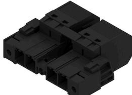
Striscia di connettori maschio inversi a 180° con tecnologia di collegamento PUSH IN per il cablaggio in campo da 6 mm<sup>2</sup> con passo 7,62 come "variante a tre flange" del passaggio nella custodia. Ideale per custodie con spessore max. di parete 2 mm.
