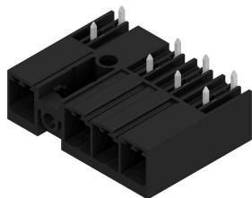
Striscia di connettori maschio a 270° con flangia centrale con passo 7,62. Soddisfa i requisiti della norma IEC 61800-5-1 e attiva la certificazione UL secondo la norma UL840 600 V. Senza una striscia di connettori femmina, il controprofilo garantisce una protezione minima contro i contatti accidentali >3 mm con una pressione di 20 N sul dito di prova.
