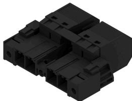
Striscia di connettori maschio inversi a 180° con tecnologia di collegamento PUSH IN per il cablaggio in campo da 6 mm<sup>2</sup> con passo 7,62 come "variante a tre flange" del passaggio nella custodia. Ideale per custodie con spessore max. di parete 2 mm. Ideale anche come soluzione di protezione dita per le tensioni inverse. Soddisfa i requisiti delle norme UL1059 600 V classe C e IEC 61800-5-1.
