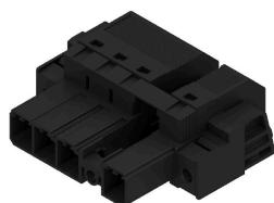
Striscia di connettori maschio inversi a 180° con tecnologia di collegamento PUSH IN per il cablaggio in campo da 6 mm<sup>2</sup> con passo 7,62 come "variante a tre flange" del passaggio nella custodia. Ideale per custodie con spessore max. di parete 16 mm.
