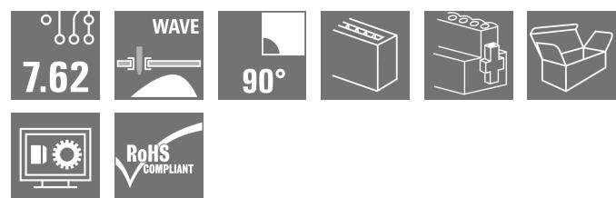
Connettore femmina a 90° per il circuito stampato con passo di 7,62. Soddisfa i requisiti IEC 61800-5-1 e attiva la certificazione UL secondo la norma UL840 600 V.
