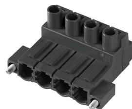
Connettore maschio inverso a 180° con collegamento a staffa di serraggio per il cablaggio in campo da 2,5 mm<sup>2</sup> con passo 7,62. Ideale anche come soluzione di protezione contro i contatti accidentali per le tensioni inverse.
