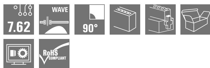
Connettore femmina a 90° per il circuito stampato con passo di 7,62. Soddisfa i requisiti IEC 61800-5-1 e attiva la certificazione UL secondo la norma UL840 600 V.
