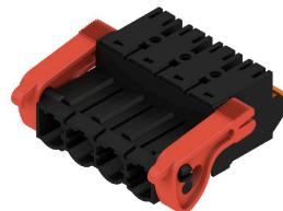
Striscia di connettori maschio inversi a 180° con tecnologia di collegamento PUSH IN per il cablaggio in campo da 2,5 mm<sup>2</sup> con passo 7,62. Ideale anche come soluzione di protezione contro i contatti accidentali per le tensioni inverse.
