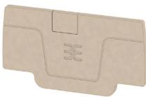
Le piastrine terminali sono fissate sul lato aperto dell'ultimo morsetto componibile prima del terminale di fissaggio. Inserendo la piastra terminale viene mantenuta la funzione del morsetto così come la tensione di dimensionamento indicata. È garantita una protezione contro parti sotto tensione e il morsetto terminale è sicuro per le dita.
