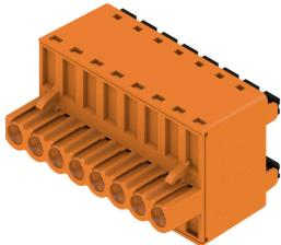
La forte soluzione "Daisy-Chain" per applicazioni di bus di segnali potenti si presta anche per catene di energia ausiliaria da 400V con una corrente di carico max. di 18,5A. Il grande volume di contatto con una sezione del cavo fino a 2,5mm<sup>2</sup>, grazie alla minore caduta di tensione, è particolarmente vantaggioso con cavi bus lunghi o con correnti elevate.
