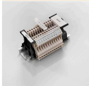
I portacartellini di gruppo SchT 5 S sono fissati direttamente alla guida di supporto TS 32 (guida G) o TS 35 (guida DIN). Quindi l'identificazione della morsettiera è possibile indipendentemente dal punto di serraggio e dal tipo di morsetto.
