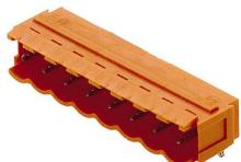
Connettori maschio con direzione d#92uscita a 90°. La lunghezza dei codoli a saldare è ottimizzata per saldature ad onda. I connettori presentano uno spazio per la siglatura e possono essere codificati.
