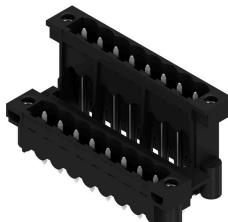
Connettore maschio resistente alle alte temperature, su due piani, sfalsato lateralmente, con flangia ovvero flangia a saldare. Lunghezza codolo 1,5 mm adatto per applicazioni di saldatura Reflow. Codolo di 3,2 mm adatto a saldature ad onda e Reflow. I connettori presentano uno spazio per la siglatura e possono essere codificati.
