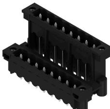
Connettore maschio resistente alle alte temperature, su due piani, sfalsato lateralmente, con flangia ovvero flangia a saldare. Lunghezza codolo 1,5 mm adatto per applicazioni di saldatura Reflow. Codolo di 3,2 mm adatto a saldature ad onda e Reflow. I connettori presentano uno spazio per la siglatura e possono essere codificati.
