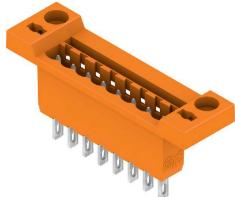
Connettore maschio per montaggio in feritoia su piastra frontale con funzione di bloccaggio opzionale. Collegamento interno a spina piatta o a saldare. I connettori sono siglabilini e possono essere codificati.
