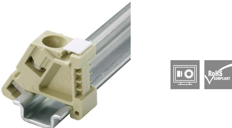
Per garantire un posizionamento sicuro e durevole sulla guida di supporto ed evitare uno spostamento, Weidmüller fornisce terminali di fissaggio. Sono disponibili esecuzioni con vite e senza vite. Sui terminali di fissaggio è possibile applicare delle siglature, anche per cartellini di gruppo, oltre che alloggiare le spine di prova.
