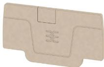
Le piastr terminali sono fissate sul lato aperto dell'ultimo morsetto componibile prima del terminale di fissaggio. Inserendo la piastra terminale viene mantenuta la funzione del morsetto così come la tensione di dimensionamento indicata. È garantita una protezione contro parti sotto tensione e il morsetto terminale è sicuro per le dita.
