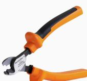
Outils à couper pour conducteurs jusqu'à 8 mm, 12 mm, 14 mm et 22 mm de diamètre extérieur. La géométrie de coupe spéciale assure une coupe nette et sans écrasement des conducteurs en cuivre et aluminium avec un effort physique minimum. En outre, les outils de coupe (KT 8 à KT 22) sont munis d'une protection isolante testée VDE et GS jusqu'à 1 000 V, conformément aux normes EN/CEI 60900.
