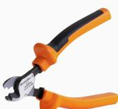
Outils à couper pour conducteurs jusqu'à 8 mm, 12 mm, 14 mm et 22 mm de diamètre extérieur. La géométrie de coupe spéciale assure une coupe nette et sans écrasement des conducteurs en cuivre et aluminium avec un effort physique minimum. En outre, les outils de coupe (KT 8 à KT 22) sont munis d'une protection isolante testée VDE et GS jusqu'à 1 000 V, conformément aux normes EN/CEI 60900.
