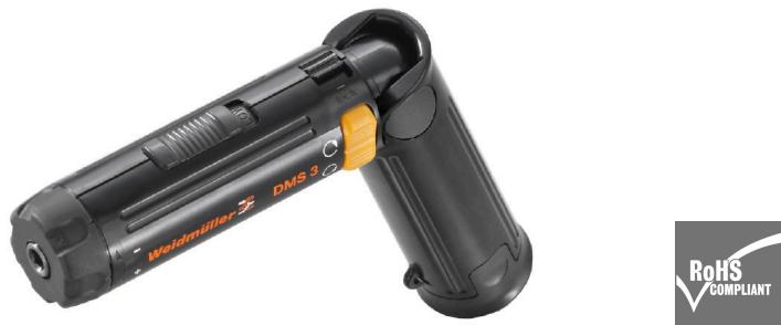
Les tournevis dynamométrique Weidmüller ont une forme ergonomique et se prêtent bien de ce fait à une utilisation d'une seule main. Ils permettent de travailler sans fatigue dans toutes les directions de montage. Vous disposez en plus d'une limitation automatique du couple et d'une grande précision de reproductibilité.
