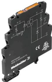
Relais statiques compacts et puissants au format d'un bloc de jonction
