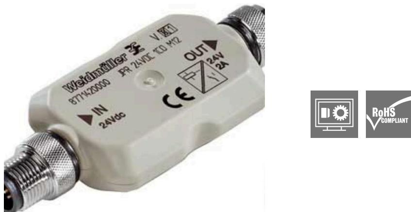
Les interfaces relais JPR en boîtier JACKPAC IP68 existent avec ou sans isolation galvanique. L'amplificateur de commutation amplifie les sorties 24 V DC jusqu'à 2 A max. La tension de commutation est amenée par un répartiteur en T.
