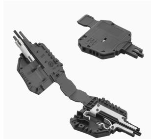
Le support fusible SIHA permet de transformer en un tour de main un bloc de jonction sectionnable en bloc de jonction à fusible : il suffit simplement de remplacer le levier de sectionnement par une fiche fusible.
