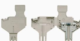
La fiche avec composant est utilisée pour intégrer des composants électriques dans un bloc de jonction sectionnable. Après avoir soudé les composants électriques, le mâle peut être intégré dans la zone de déconnexion de nos blocs de jonction sectionnable et change ainsi le bloc de jonction sectionnable en bloc de jonction modulaire avec composants électriques intégrés.
