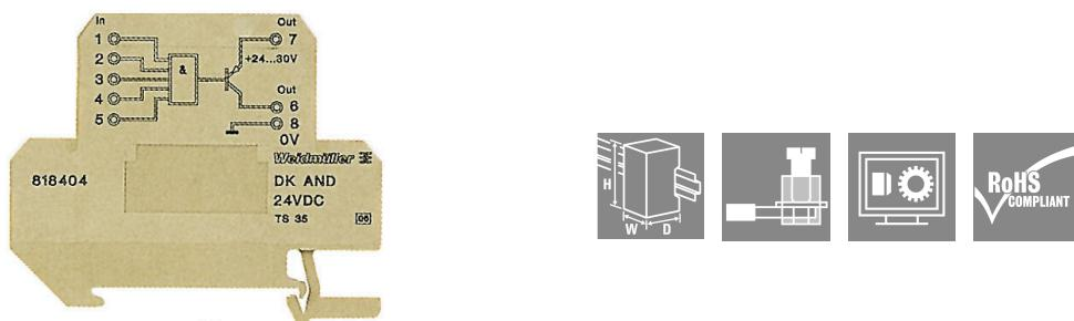
Fonctions logiques AND, NAND, OR et NOR au format bloc de jonction avec section nominale de 4 mm<sup>2</sup>. Ils disposent de 5 entrées, qui sont combinées sur une sortie PNP 24 V/ 20 mA. Les modules logiques offrent de nombreuses possibilités d'application pour raccorder les signaux capteurs actionneurs dans les systèmes d'automatisme.
