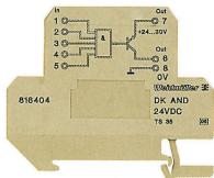
Fonctions logiques AND, NAND, OR et NOR au format bloc de jonction avec section nominale de 4 mm<sup>2</sup>. Ils disposent de 5 entrées, qui sont combinées sur une sortie PNP 24 V / 20 mA. Les modules logiques offrent de nombreuses possibilités d'application pour raccorder les signaux capteurs actionneurs dans les systèmes d'automatisme.
