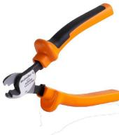
Outils à couper pour conducteurs jusqu'à 8 mm, 12 mm, 14 mm et 22 mm de diamètre extérieur. La géométrie de coupe spéciale assure une coupe nette et sans écrasement des conducteurs en cuivre et aluminium avec un effort physique minimum. En outre, les outils de coupe (KT 8 à KT 22) sont munis d'une protection isolante testée VDE et GS jusqu'à 1 000 V, conformément aux normes EN/CEI 60900.
