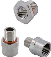
Les adaptateurs de la série ADAP offrent flexibilité et polyvalence en remplaçant les entrées inutilisées des équipements Ex, tout en maintenant une protection antidéflagrante Ex d, une protection contre les explosions Ex e à sécurité accrue et un indice de protection IP66/67/68.
