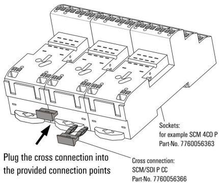
Comment installer la connexion transversale sur les contacts A2 (connexion transversale) du SCM... Prises PUSH IN
