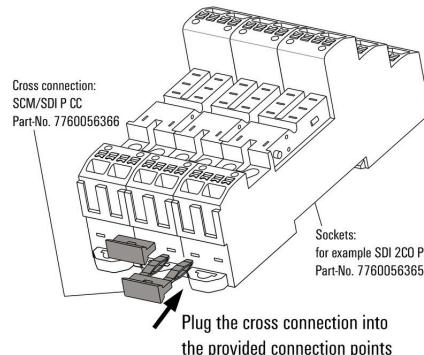
Comment installer la connexion transversale sur les contacts A2 (connexion transversale) du SDI... Prises PUSH IN
