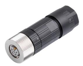
Vos appareils périphériques ont besoin d'une alimentation plus forte. Nos nouveaux connecteurs débrochables M12 supportent sans problème 250 V et 2 A. Les connecteurs débrochables compacts M12 à codage A, K, L, S et T sont conçus pour transmettre jusqu'à 630 V AC ou 60 V DC et 12 A.
