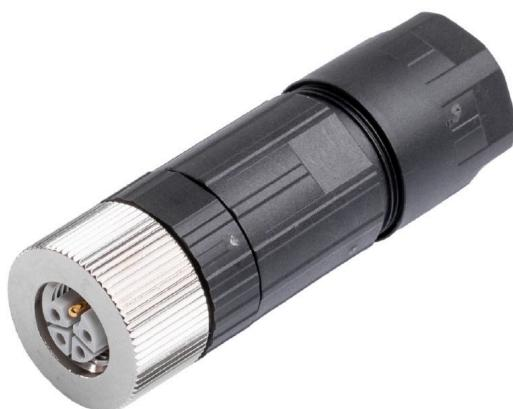
Vos appareils périphériques ont besoin d'une alimentation plus forte. Nos nouveaux connecteurs débrochables M12 supportent sans problème 250 V et 2 A. Les connecteurs débrochables compacts M12 à codage A, K, L, S et T sont conçus pour transmettre jusqu'à 630 V AC ou 60 V DC et 12 A.
