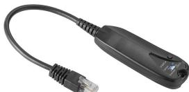
Module permettant de sauvegarder et de charger une configuration d'appareil
