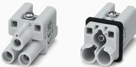
La série HQ – de petites dimensions et pourtant si grande. Les caractéristiques électriques parlent d'elles-mêmes. Le niveau de raccordement du fil est conçu pour une vis axiale. Cette technologie permet au conducteur d'être connecté sans outils spéciaux. Une simple clé à six pans suffit.
