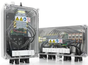
Pour un arrêt à distance sécurisé Les systèmes photovoltaïques de toit peuvent demander un appareil de déconnexion à l'endroit où les câbles pénètrent dans le bâtiment, qui est connecté au réseau de puissance dans le bâtiment. Cela permet aux pompiers d'intervenir en cas d'urgence sans être inutilement mis en danger. Lorsque l'alimentation électrique est rétablie, l'interrupteur de pompier PV Next reconnecte automatiquement les lignes PV.
