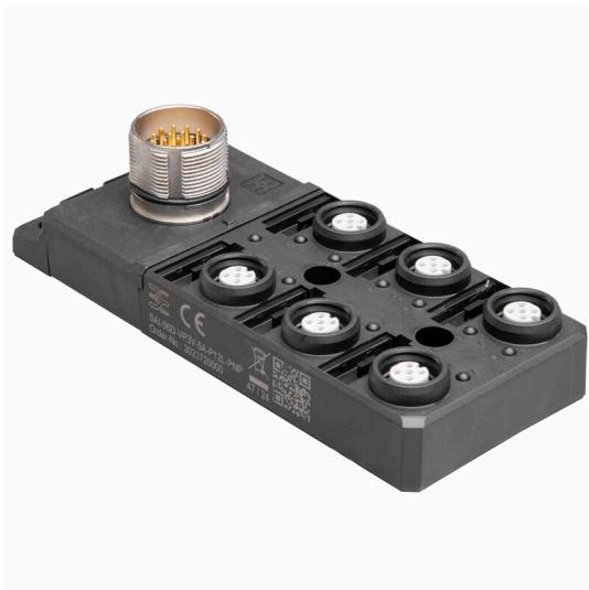
Alors qu'avec le système standard M12 le vissage du connecteur prend beaucoup de temps et qu'il est sensible aux vibrations, le système Push-Pull travaille en un seul clic comme le raccordement des tuyaux d'arrosage dans les jardins. Le déclic de verrouillage que l'on peut entendre garantit un raccordement sûr et fiable ainsi qu'une étanchéité élevée. Les nouveaux répartiteurs SAI-Push-Pull peuvent aussi bien être utilisés avec des connecteurs M12 qu'avec les nouveaux connecteurs Push-Pul.
