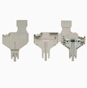
La fiche avec composant est utilisée pour intégrer des composants électrique dans un bloc de jonction sectionnable. Après avoir soudé les composants électroniques, le mâle peut être intégré dans la zone de déconnexion de nos blocs de jonction sectionnable et change ainsi le bloc de jonction sectionnable en bloc de jonction modulaire avec composants électroniques intégrés.
