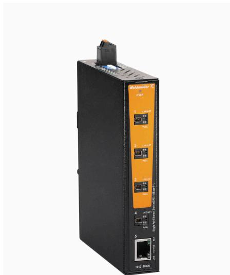
L'interrupteur SPE non administrable de Weidmüller offre la solution pour une mise en réseau fiable et efficace. Il permet le pontage de grandes distances de 1000 m en utilisant le standard SPE 10Base-T1L (10 Mbit/s). L'utilisation de cet interrupteur élimine le besoin de sous-systèmes ou de passerelles, simplifiant l'infrastructure du réseau et réduisant la complexité.
