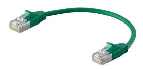
Cordons confectionnés avec 2x RJ45, adaptés aux applications de mesure intelligentes, couleurs différentes selon DIN VDE 0603-100. Mâles courts et câbles avec petit rayon de courbure pour les espaces restreints, boîtier du connecteur avec isolation circonférentielle permettent la classe de protection IP30 en état accouplé.
