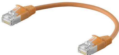
Cordons confectionnés avec 2x RJ45, adaptés aux applications de mesure intelligentes, couleurs différentes selon DIN VDE 0603-100. Mâles courts et câbles avec petit rayon de courbure pour les espaces restreints, boîtier du connecteur avec isolation circonférentielle permettent la classe de protection IP30 en état accouplé.
