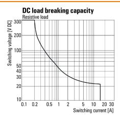
Courbe de charge limite DC Charge résistive
