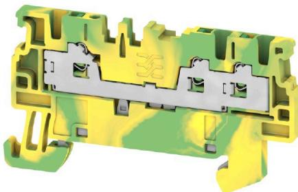
L'alimentation en énergie, signaux et données est une exigence classique en ingénierie électrique et en réalisation d'armoires. Le matériau isolant, la technique de raccordement et la conception des blocs de jonction sont les caractéristiques distinctives. Un bloc de jonction traversant est adapté pour relier et/ou raccorder un ou plusieurs conducteurs. Ils peuvent avoir un ou plusieurs niveaux de raccordement qui ont le même potentiel ou qui sont isolés les uns par rapport aux autres.
