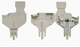
La fiche avec composant est utilisée pour intégrer des composants électrique dans un bloc de jonction sectionnable. Après avoir soudé les composants électroniques, le mâle peut être intégré dans la zone de déconnexion de nos blocs de jonction sectionnable et change ainsi le bloc de jonction sectionnable en bloc de jonction modulaire avec composants électroniques intégrés.
