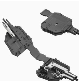
Le support fusible SIHA permet de transformer en un tour de main un bloc de jonction sectionnable en bloc de jonction à fusible : il suffit simplement de remplacer le levier de sectionnement par une fiche fusible.
