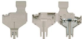
La fiche avec composant est utilisée pour intégrer des composants électrique dans un bloc de jonction sectionnable. Après avoir soudé les composants électroniques, le mâle peut être intégré dans la zone de déconnexion de nos blocs de jonction sectionnable et change ainsi le bloc de jonction sectionnable en bloc de jonction modulaire avec composants électroniques intégrés.
