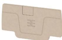
Les flasques de fermeture sont placées à l'extrême ouverte du bornier, avant l'équerre de blocage. L'utilisation des flasques de fermeture permet de conserver les caractéristiques des blocs de jonction comme par exemple la tension nominale. On évite ainsi le contact avec les pièces sous tension et le dernier bloc de jonction est protégé contre l'accès des doigts .
