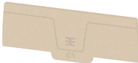
Les flasques de fermeture sont placées à l'extrême ouverte du bornier, avant l'équerre de blocage. L'utilisation des flasques de fermeture permet de conserver les caractéristiques des blocs de jonction comme par exemple la tension nominale. On évite ainsi le contact avec les pièces sous tension et le dernier bloc de jonction est protégé contre l'accès des doigts .
