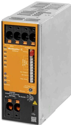
L'unité de commande ASI, associée au module de batterie et à l'alimentation électrique, constitue un système ASI DC. En fonctionnement normal, la tension d'entrée issue de l'unité de commande ASI est raccordée directement à la charge. En cas de défaillance du réseau (chute de la tension DC en entrée), le système bascule instantanément en mode batterie. Dès le rétablissement du réseau, le système revient en mode normal et la batterie est rechargée par un chargeur intégré.
