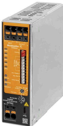
L'unité de commande ASI, associée au module de batterie et à l'alimentation électrique, constitue un système ASI DC. En fonctionnement normal, la tension d'entrée issue de l'unité de commande ASI est raccordée directement à la charge. En cas de défaillance du réseau (chute de la tension DC en entrée), le système bascule instantanément en mode batterie. Dès le rétablissement du réseau, le système revient en mode normal et la batterie est rechargée par un chargeur intégré.
