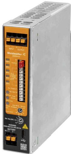
L'unité de commande ASI, associée au module de batterie et à l'alimentation électrique, constitue un système ASI DC. En fonctionnement normal, la tension d'entrée issue de l'unité de commande ASI est raccordée directement à la charge. En cas de défaillance du réseau (chute de la tension DC en entrée), le système bascule instantanément en mode batterie. Dès le rétablissement du réseau, le système revient en mode normal et la batterie est rechargée par un chargeur intégré.
