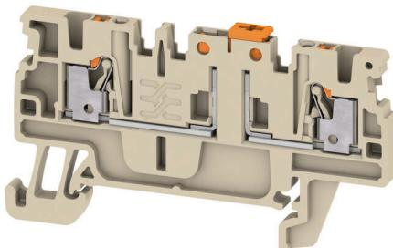
Dans certaines applications, il est logique d'ajouter un point de test ou un élément de déconnexion au terminal traversant à des fins de test et de sécurité. Avec les blocs de jonction sectionnables de test, vous mesurez les circuits électriques en l'absence de tension. Bien que la ligne d'air et de fuite des points de déconnexion ne soit pas évaluée en termes dimensionnels, la force de tension de choc nominale spécifiée doit être prouvée.
