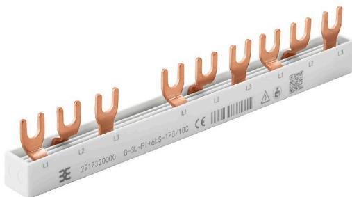
Les barres de distribution de phase de type de fourche à 3 pôles sont utilisées pour la distribution de potentiel à d'autres composants dans l'armoire de commande tels que les disjoncteurs, les disjoncteurs de courant résiduels et d'autres dispositifs d'installation.
