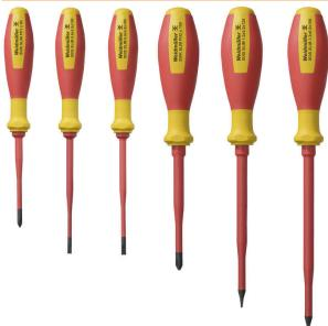
Tournevis isolés VDE Weidmüller SoftFinish electric pour intervention sur pièces sous tension jusqu'à 1000 V AC et 1500 V DC, DIN EN 60900, IEC 900. Sécurité contrôlée "GS", testée unitairement. Lame en alliage chrome-vanadium-molybdène-acier de haute qualité, entièrement durcie, brunie.
