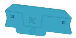
Les flasques de fermeture sont placées à l'extrémité ouverte du bornier, avant l'équerre de blocage. L'utilisation des flasques de fermeture permet de conserver les caractéristiques des blocs de jonction comme par exemple la tension nominale. On évite ainsi le contact avec les pièces sous tension et le dernier bloc de jonction est protégé contre l'accès des doigts .
