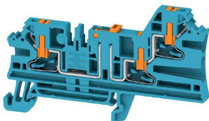
Dans certaines applications, il est logique d'ajouter un point de test ou un élément de déconnexion au terminal traversant à des fins de test et de sécurité. Avec les blocs de jonction sectionnables de test, vous mesurez les circuits électriques en l'absence de tension. Bien que la ligne d'air et de fuite des points de déconnexion ne soit pas évaluée en termes dimensionnels, la force de tension de choc nominale spécifiée doit être prouvée.
